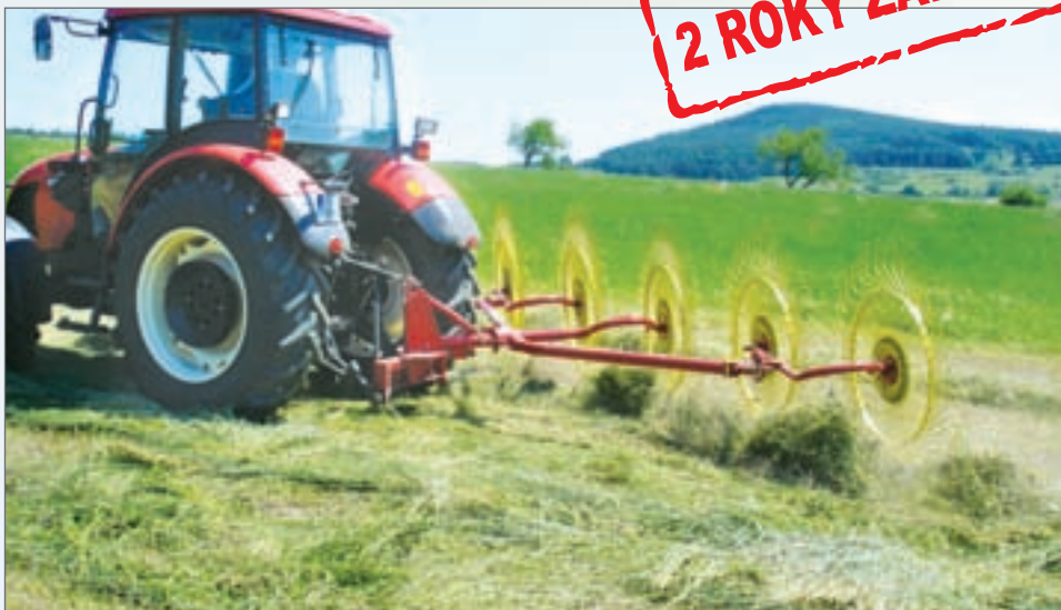
SP4-205 UNIVERZÁLNÍ OBRACEČ A SHRNOVAČ
