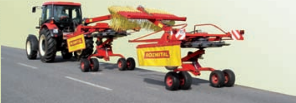
SB - 1352 dvourotorový shrnovač, boční
