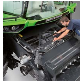
Kryty šikmého dopravníku umožňují po otevření snadnou kontrolu a údržbu všech jeho hlavních komponent
