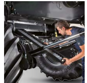
Stupňovitá vynášecí deska je dostupná z přední části skrz lapač kamenů
