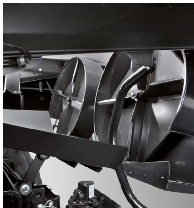
Metač plev s novým dopravníkem a kanály přivádějícími plevy přímo do čtyřlopatkových rotorů
