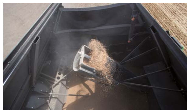
Všechny modely jsou vybaveny velkokapacitním zásobníkem zrna o objemu 9 500 litrů
