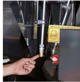
Volitelně může být stroj vybaven vzduchovým kompresorem umístěným za chladiči, celý systém má celkem 3 vývody – dva na každé straně a jeden v motorovém prostoru
