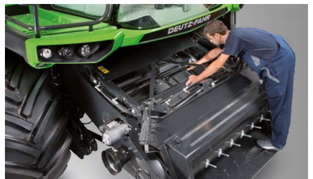
Široký servisní otvor v horní části dopravníku usnadňuje přístup k řetězovému ústrojí pro snadnou a rychlou údržbu
