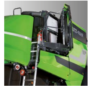
Všechny chladiče jsou otevřitelné pro jednoduché čištění, ke kterému slouží integrovaná výsuvná plošina
